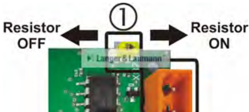
Fig. 3 : Module TSG CANopen Lift - terminaison du bus
