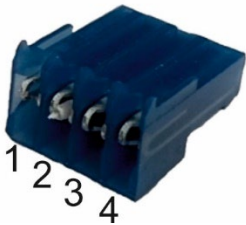
Abb. 5: 4-poliger CAN Anschluss XF5
